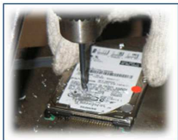
分解し、ドリルでの穴あけによる物質的破壊
